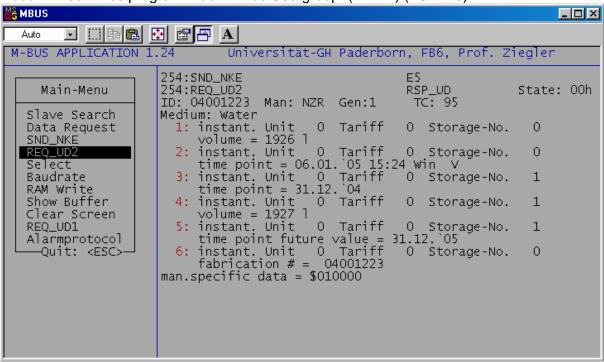
**Beispiel-Telegramm:** Das folgende Beispiel zeigt eine Auslesung des Modularis M-Bus Modul mit der Mbus Applikation von Michel Rac : (V 1.17)
