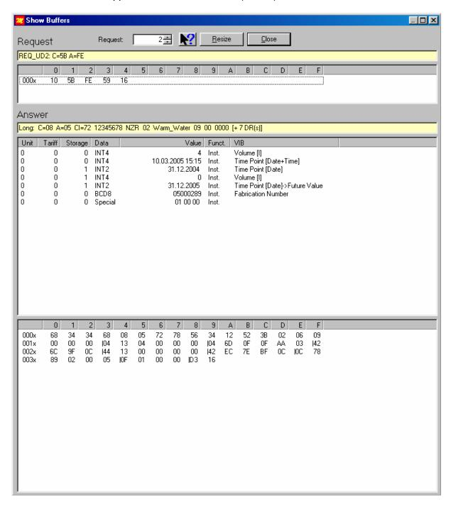
**Beispiel-Telegramm:** Das folgende Beispiel zeigt eine Auslesung des Modularis M-Bus Modul mit der Mbus Applikation von Michel Rac : (V 1.17) FCB = 1
