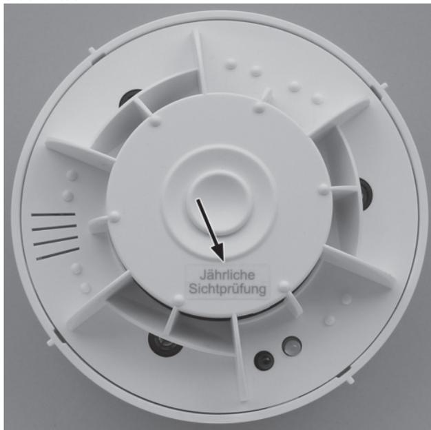
**!** Dans ce cas, le contrôle annuel prescrit est effectué manuellement – comme décrit dans le chapitre « Contrôle de fonctionnement ».
