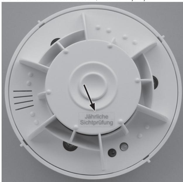
**!** Ebben az esetben az előírt éves ellenőrzést manuálisan kell elvégezni a „Működésellenőrzés” c. fejezetben leírtaknak megfelelően.
